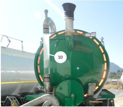
Indicador del nivel de la cisterna
