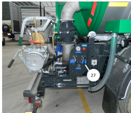
Válvula de ventilación de la cisterna
