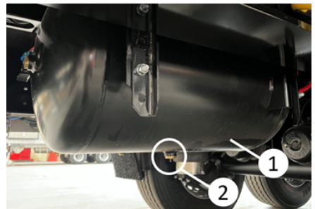
Depósitos de aire
