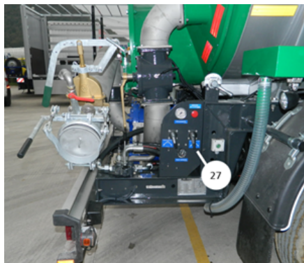
Válvula de ventilación de la cisterna
