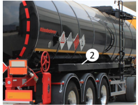
Cámara de transporte de mangueras
