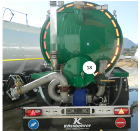
Línea de entrada de la bomba de descarga
