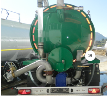
Línea de salida de la bomba de mezcla de la cisterna
