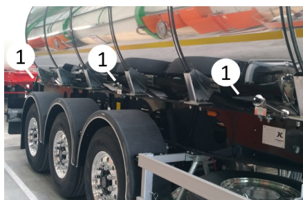
Válvulas de descarga laterales
