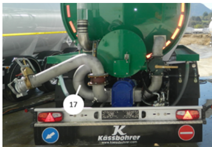
Conduite d'entrée de la pompe de mélange de la citerne
