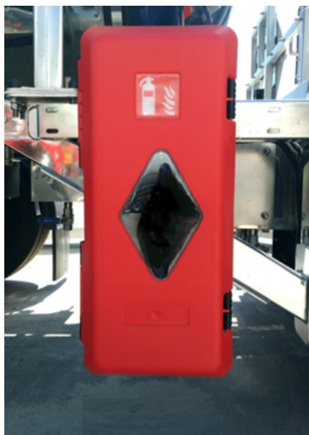
Armoire à extincteurs
