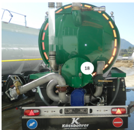
Ligne d'entrée de la pompe de déchargement
