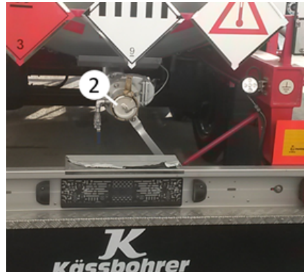
Buse de déchargement
