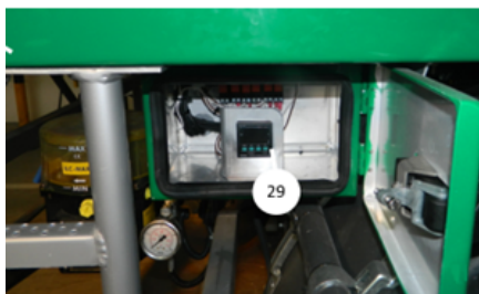
Système de comptage électronique de la lubrification centralisée
