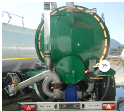
Conduite de sortie de la pompe de mélange de citerne
