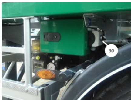
Bouton de marche/arrêt de la lubrification centralisée
