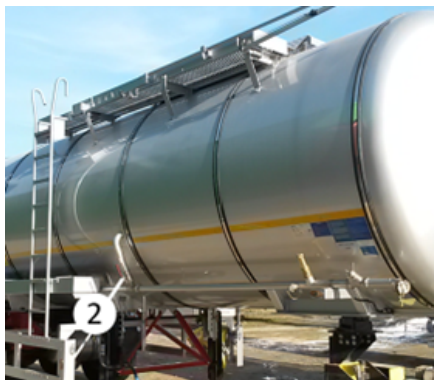
Conduite d'air supérieure
