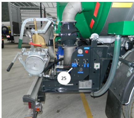
Vanne de l'entonnoir de remplissage
