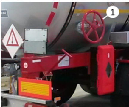
Volant d'ouverture de la vanne de fond
