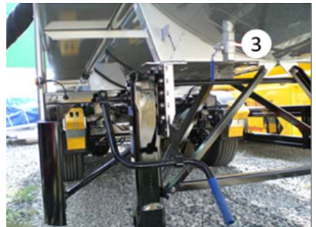
Vanne sous la citerne
