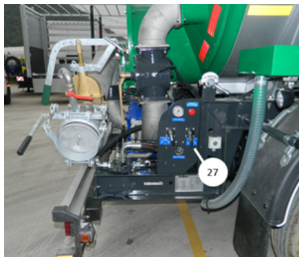
Valve de ventilation de la citerne
