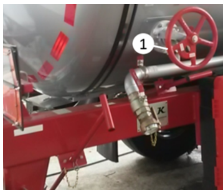
Sterowanie otwarciem zaworu dennego za pomocą koła ręcznego
