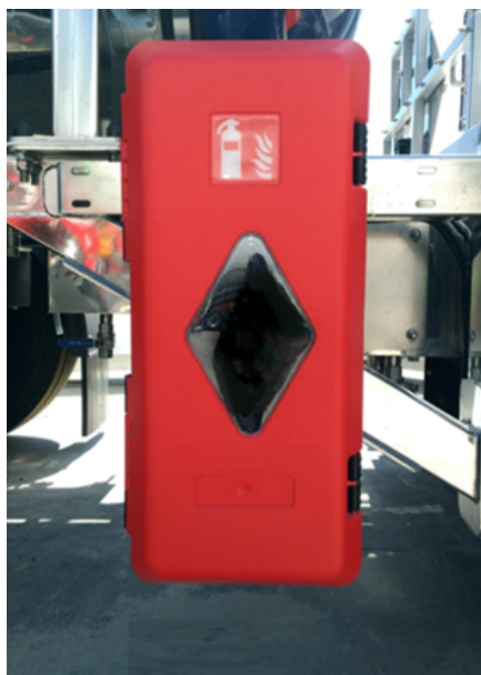
Szafka na gaśnicę
