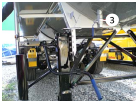
Zawór pod zbiornikiem
