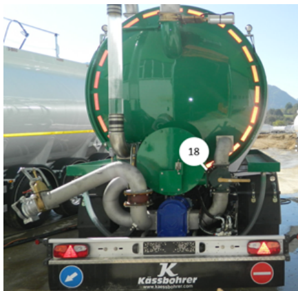
Przewód wlotowy pompy rozładunkowej
