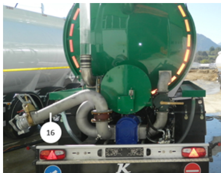
Przewód wylotowy pompy rozładunkowej
