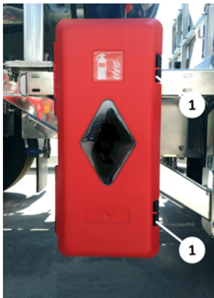
Szafka na gaśnice
