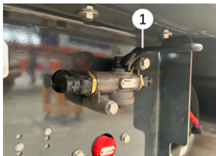
Válvula de desbloqueo del eje orientable
