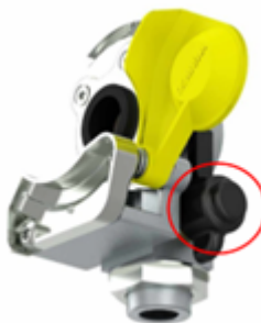
Acoplamiento de palma con punto de prueba
