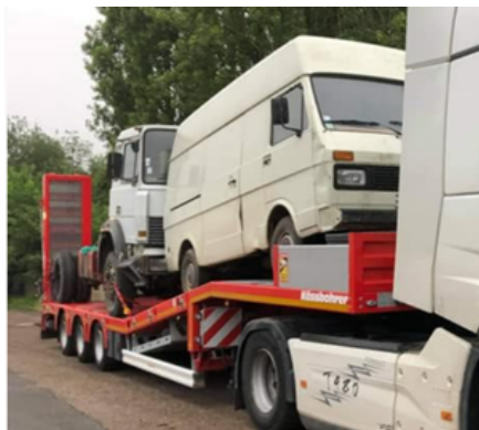
Ejemplo de utilización de una rampa de cuello de cisne hidráulica
