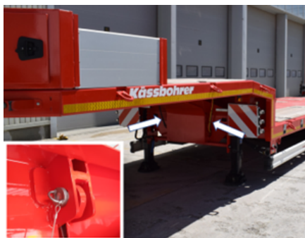
Posición de los pasadores de seguridad
