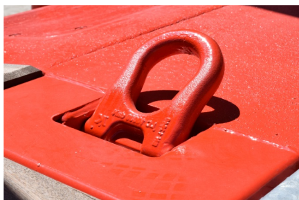
Anillo de aseguramiento de la carga retirada
