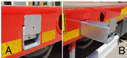
Soportes de ampliación
