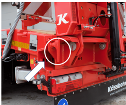
Bloqueo de seguridad de la rampa
