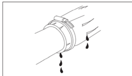
Fuga de aceite en conexiones hidráulicas y neumáticas
