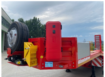
Armario para extintores
