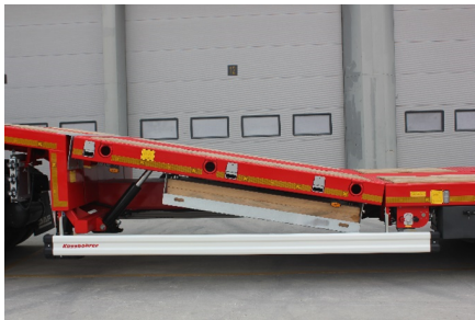
Posición superior de la rampa
