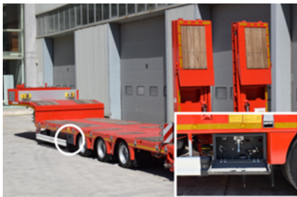
Posición del armario de control en el vehículo de góndola
