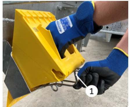
Extracción del calzo de la carcasa
