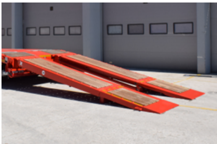
Posición baja de la rampa hidráulica
