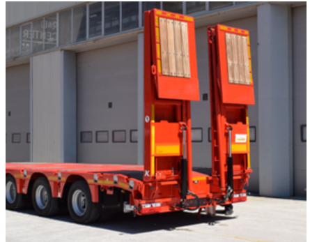
Posición elevada de la rampa hidráulica
