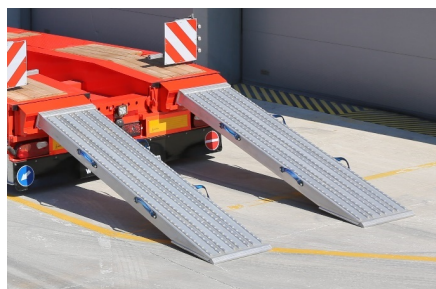
Rampas utilizadas en la zona del parachoques
