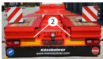
Lengüetas de inserción de la rampa en el parachoques
