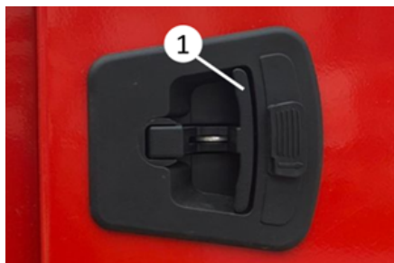
Cerradura y pestillo de la puerta lateral
