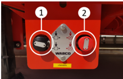
Elementos de mando de los frenos
