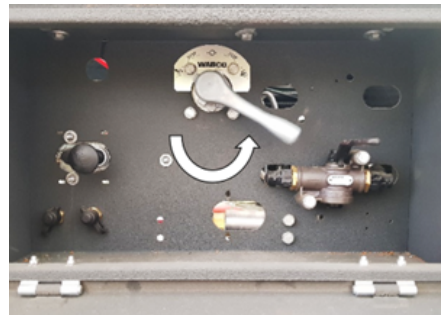
Elevación de la suspensión
