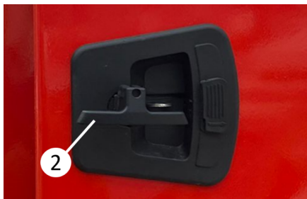
Extracción y giro del pestillo
