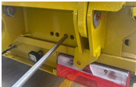
Desplazamiento de la rampa mecánica con ayuda de una palanca
