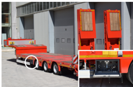
Ubicación del armario de control en el vehículo de plataforma baja
