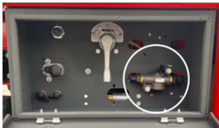
Posición de la válvula de bloqueo del eje direccional
