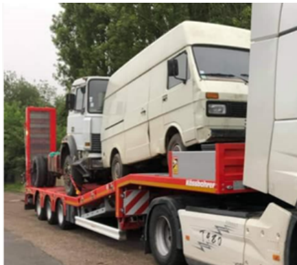
Exemple d'utilisation d'une rampe hydraulique du col de cygne
