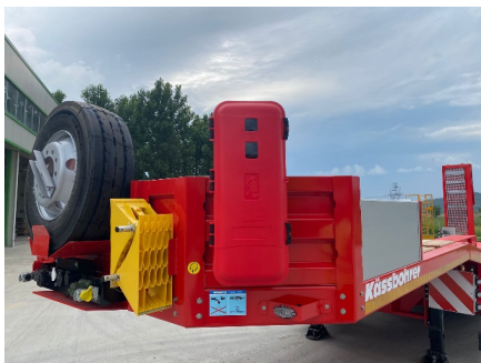
Armoire à extincteurs
