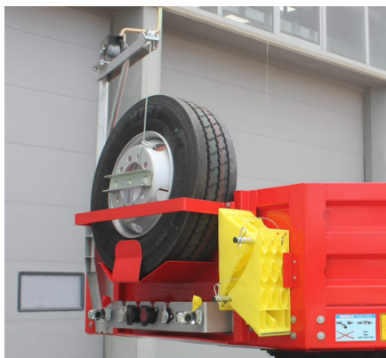
Treuil d'abaissement de la roue de secours
