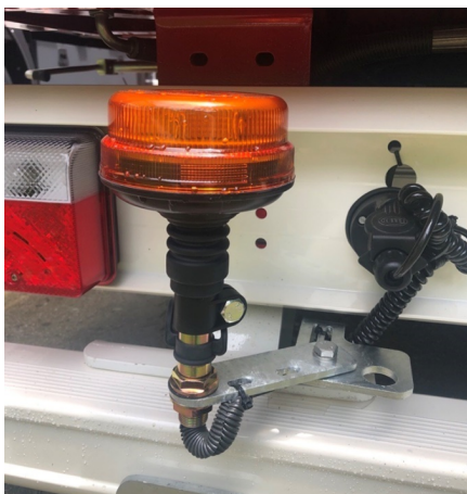
Feu d'avertissement tournant à diodes électroluminescentes
