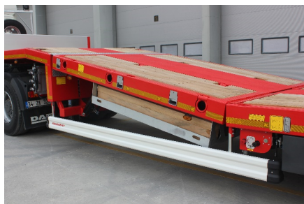
Rampe hydraulique du col de cygne
