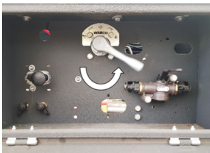
Levage de la suspension
