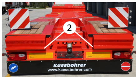
Pattes de fixation de la rampe sur le pare-chocs
