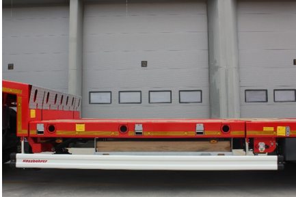
Position inférieure de la rampe
