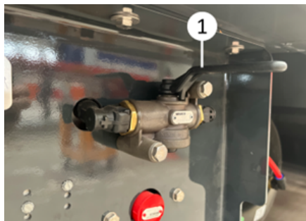
Valve de déverrouillage de l'essieu directeur
