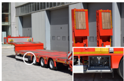
Emplacement de l'armoire de commande dans le véhicule à plate-forme surbaissée
