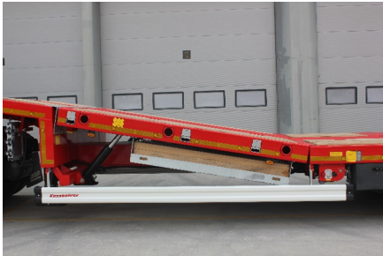
Position supérieure de la rampe
