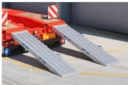
Rampes utilisées dans la zone de pare-chocs
