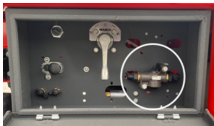
Position de la valve de verrouillage de l'essieu directeur
