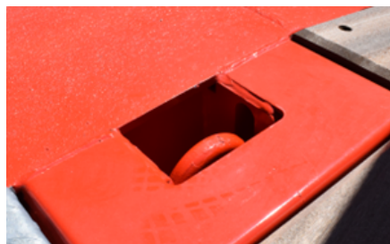
Anneau d'arrimage de la charge enterré
