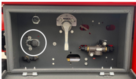
Bouton champignon de relevage d'essieu dans l'armoire de commande
