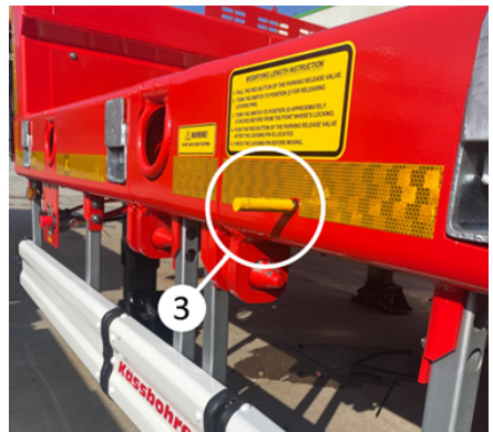
Le levier indicateur sort de la prise
