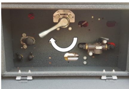
Abaissement de la suspension
