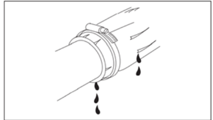
Wyciek oleju w połączeniach hydraulicznych i pneumatycznych
