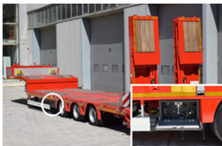
Umieszczenie szafy sterowniczej w pojeździe niskopodwoziowym
