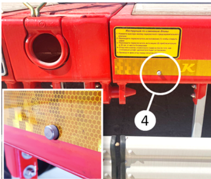
Wkładanie dźwigni wskaźnika do obudowy
