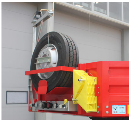
Dźwig do opuszczania opon zapasowych
