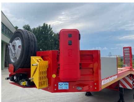
Szafka na gaśnice
