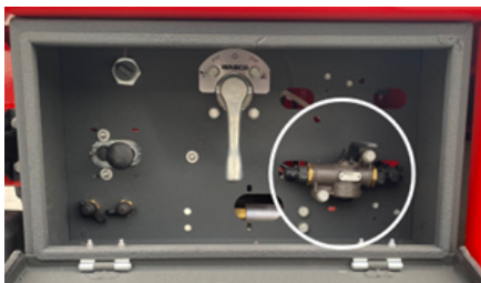
Polożenie zaworu blokady osi skrętnej
