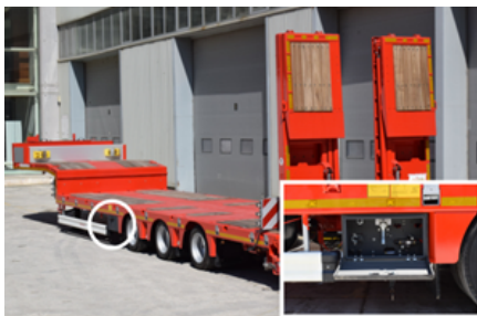
Umiejscowienie szafy sterowniczej w pojeździe gondola
