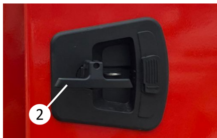
Zdejmowanie i obracanie zatrzasku blokującego
