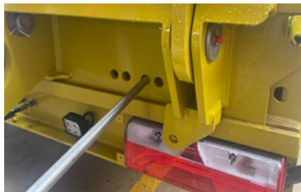
Przesuwanie rampy mechanicznej za pomocą tomu
