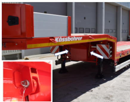
Umieszczenie kołków zabezpieczających
