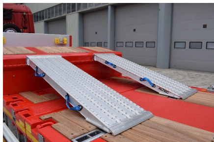
Aluminiowa rampa zastosowana w obszarze gęsiej szyi
