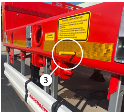
Odlączenie dźwigni wskaźnika od obudowy
