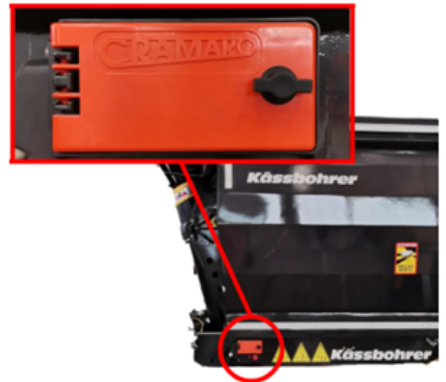
Position des Planensteuergeräts
