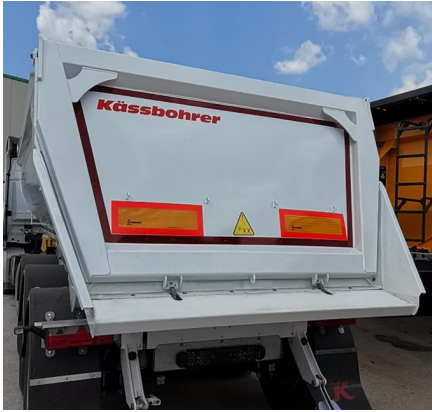
Hochklappbare hydromechanische Hintertür
