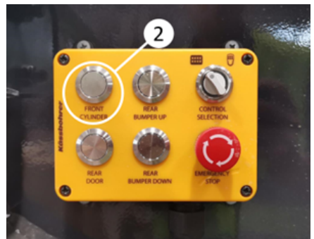
Anheben der Mulde durch Drücken der Taste für den vorderen Zylinder
