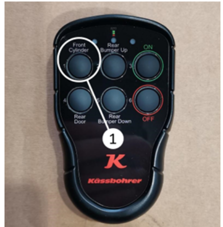
Absenken der Mulde mit der Fernbedienung
