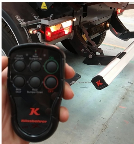
Steuerung für den automatischen Stoßfänger
