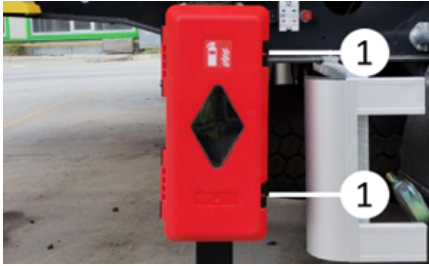
Öffnen des Feuerlöscherkabinetts
