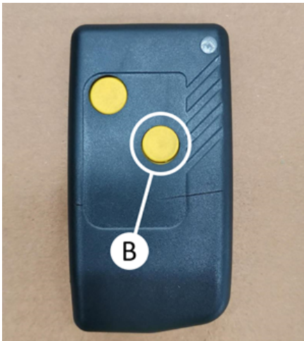
Öffnen der Plane über die Fernbedienung
