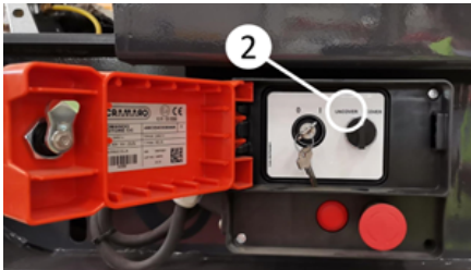
Öffnen der Plane über das Steuergerät
