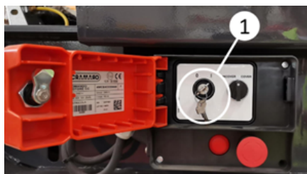
Encendido de la unidad de control
