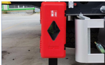
Armario para extintores
