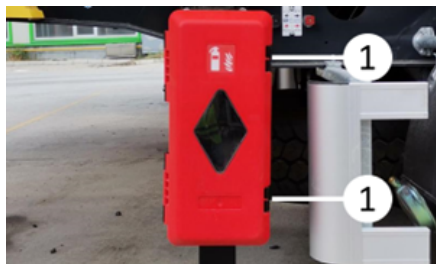
Apertura del armario de extintores
