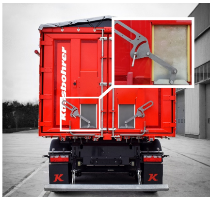
Cubierta para descarga de grano
