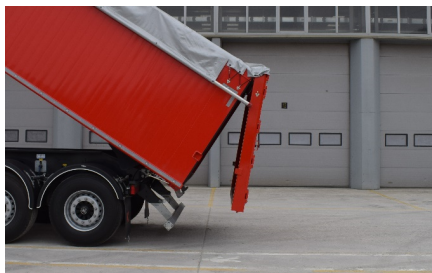
Ouverture de la porte mécanique
