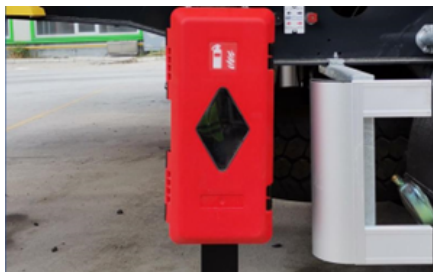
Armoire à extincteurs
