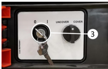
Arrêt de l'unité de commande de la bâche
