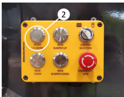
Levage de la benne en appuyant sur le bouton Front Cylinder
