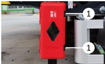
Ouverture de l'armoire à extincteurs
