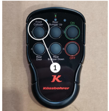
Abaissement de la benne à l'aide de la télécommande
