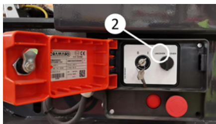
Apertura del telone dall'unità di controllo
