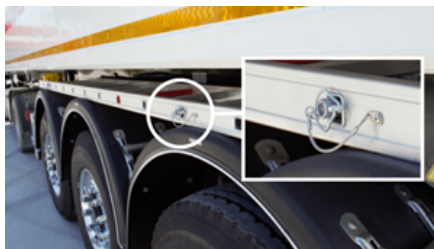
Rimozione del perno della scala mobile
