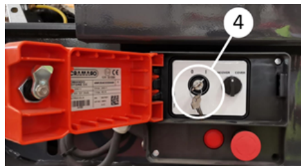
Accensione dell'unità di controllo del telone
