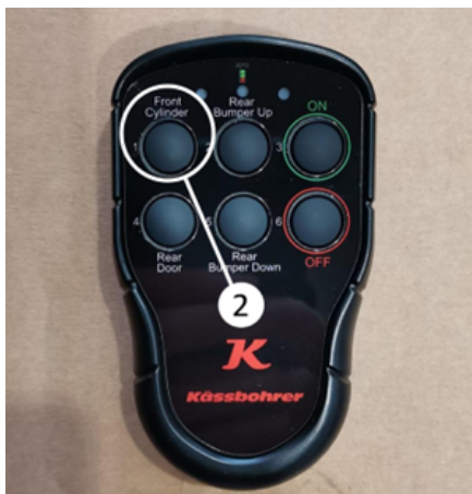
Sollevamento della vasca con il telecomando
