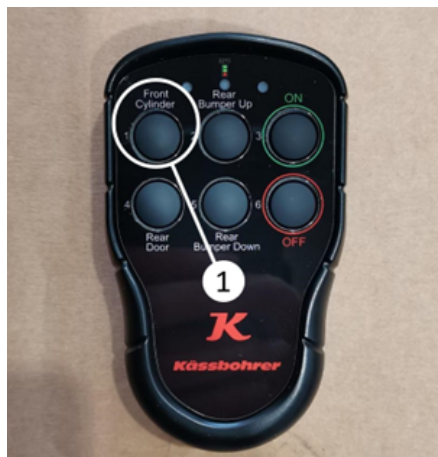
Abbassare la vasca con il telecomando
