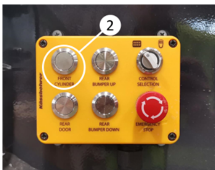
Podnoszenie wanny przez naciśnięcie przycisku siłownika przedniego
