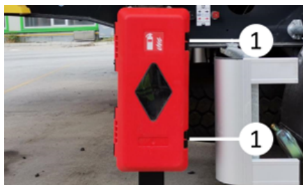
Otwieranie szafki na gaśnicę
