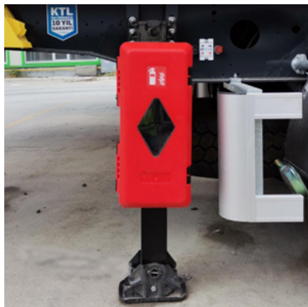
Szafka na gaśnice
