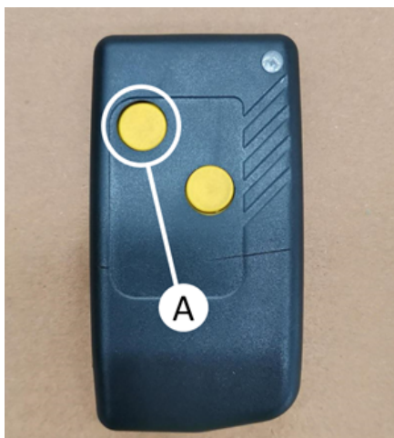
Zamykanie plandeki za pomocą pilota
