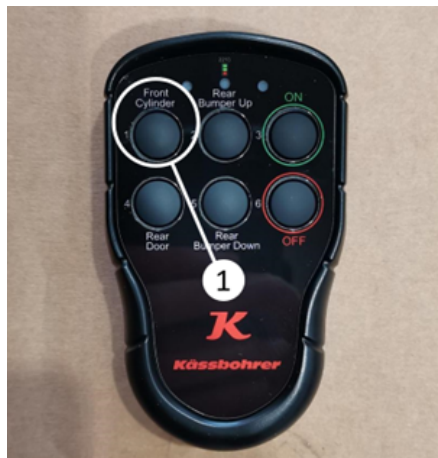
Opuszczanie wanny za pomocą pilota zdalnego sterowania
