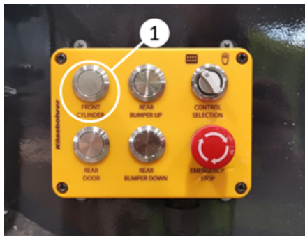
Opuszczanie wanny przez naciśnięcie przycisku siłownika przedniego
