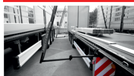
Erweiterung der mittleren Rungen
